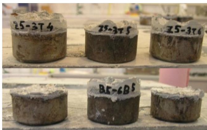
Slika 10 - Slomovi betona pripremljenih u: a) CPF oplati oznake F, b) CPF oplati oznake Z, c) klasičnoj oplati
