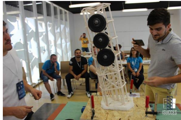
Ispitivanje modela na potresnom stolu
