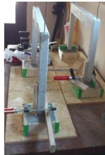
U mogućnosti je makete potresati harmonijskom uzbudom za koju je moguće varirati amplitudu u granicama 0,01 – 6 cm, te frekvenciju u granicama 0,01 – 5,00 Hz. Osim toga, makete je moguće potresati i sa skaliranim zapisima potresa Northridge zabilježenim 1994. i Kobe iz 1995.
