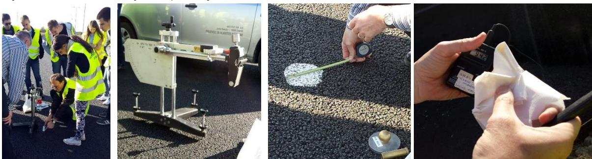
Po završetku terenske nastave, studenti su upoznati s problematikom izvedbe slojeva kolničke konstrukcije na vodozaštićenom području koja je uključivala ugradnju nepropusnih geomembrana, te s poteškoćama s postizanjem tražene nosivosti slojeva. Svi problemi su uspješno riješeni uz izvođenje neplaniranih, dodatnih ispitivanja.
