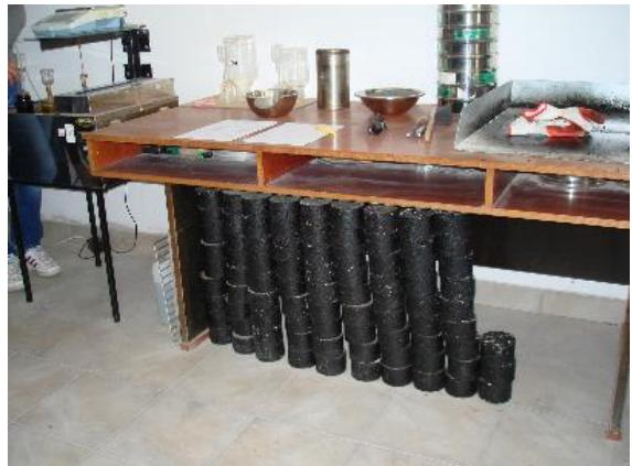
Nakon kraćeg odmora i organizirane okrjepe, studenti su detaljno upoznati s karakteristikama postrojenja te laboratorijskim ispitivanjima asfaltnih mješavina u svrhu kontrole kvalitete. Asfaltna baza *Ammann global* u Vinkovcima ima kapacitet 120 t/h i računalni sustav upravljanja najnovije generacije. Ekološkog je plinskog pogona, dok je briga o okolišu naglašena i skorim uvođenjem uporabe recikliranog asfalta te uhodavanjem proizvodnje niskotemperaturnog asfalta.
